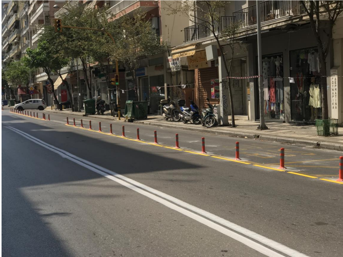
1. Διαχωρισμός της Λεωφορειολωρίδας με εύκαμπτους οριοδείκτες ύψους 45 εκ. και αποτροπή της παράνομης στάθμευσης.
