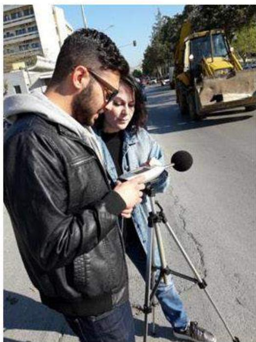
**Μέτρηση Κυκλοφοριακού θορύβου**
